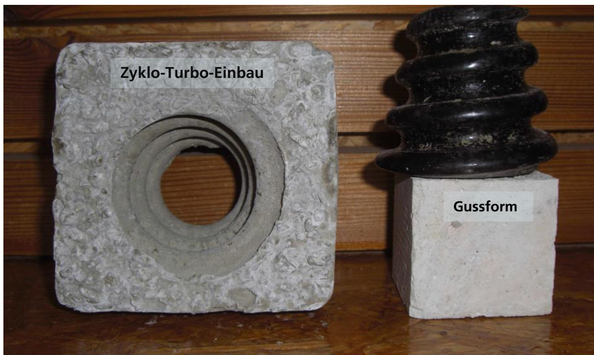
Abbildung 17: Beispiel für einen Zyklus-Turbo-Einbau (links), Innengussform (rechts).
