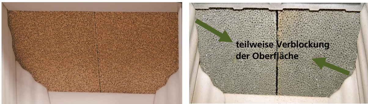
Abbildung 5: Schaumkeramik-Filterplatten im Neuzustand (links), nach zwei Betriebstagen (ca. 14 h) (rechts).
