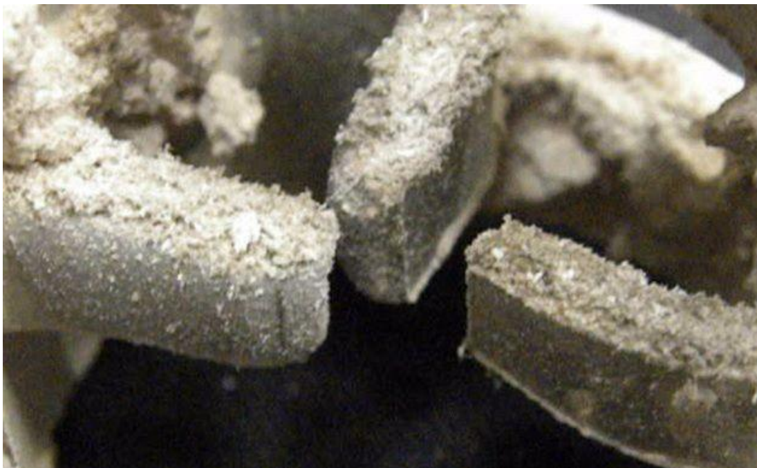
Abbildung 10: Bildung von Agglomeraten im Einbautenmodul beim Einsatz in Kleinfeuerungsanlagen.
