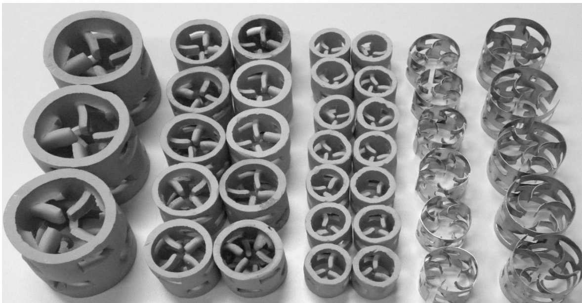
Abbildung 8: Keramische und metallische Einbauten (Füllkörper) der Firma Raschig GmbH.
