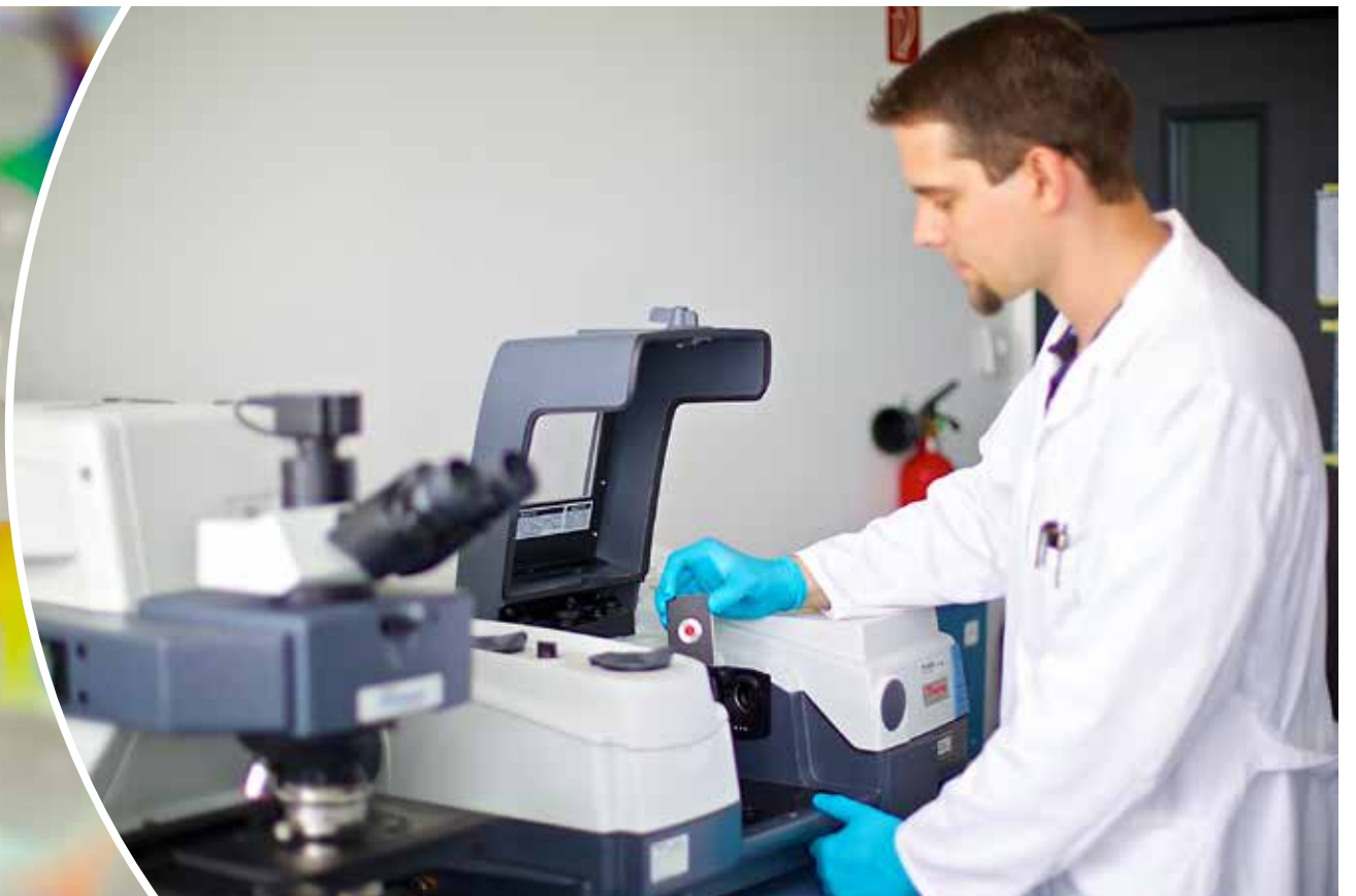
Abbildung 5: Messung mit dem Fourier-Transform-Infrarot-Spektrometer
