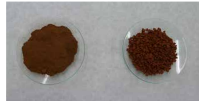
Abbildung 1: Recyclingdünger aus behandelter Klärschlamm- asche (links: Klärschlamm- asche; rechts: aschebasierter Dünger)
