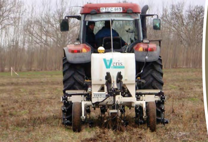
Abbildung 1: Bodensensor zur mobilen pH-Wert-Kartierung
