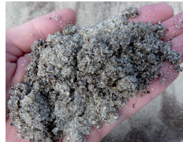
Abbildung 3: Aus dem Abwasser gewonnen: nährstoffreiches MAP Granulat
