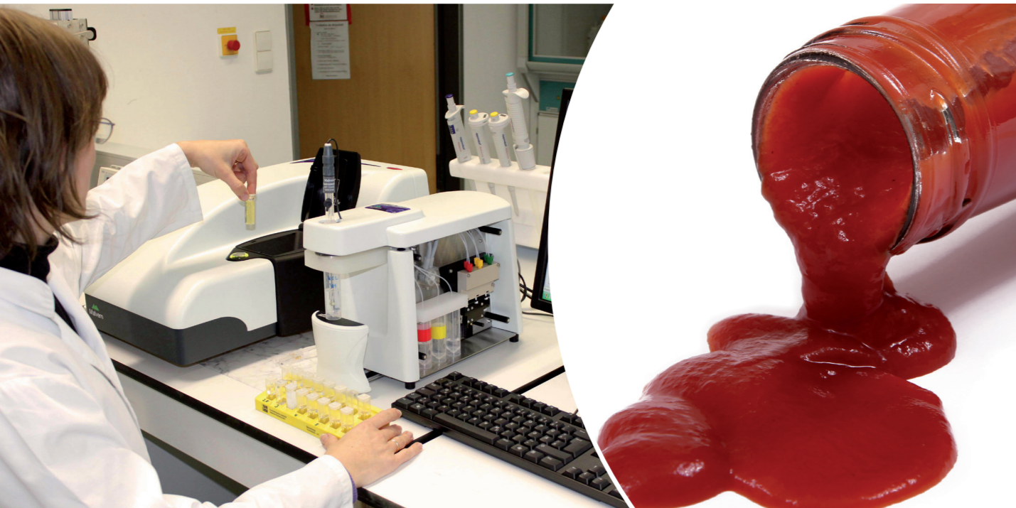
Abbildung 3: Dynamische Lichtstreuung zur Ermittlung der Partikelgrößenverteilung im Nanometerbereich und des Zetapotenzials in Lebensmitteln
