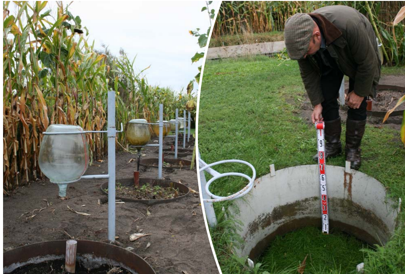
Abbildung 2: Größte Lysimeteranlage Europas in Paulinenaue; Abbildung 3: Moorsacklysimeter; 70 cm ist der Boden seit den 60er Jahren abgesackt
