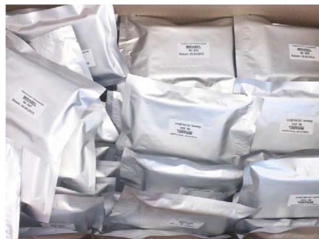
Abbildung 2c: „Ready-to-use“ PCR-Platten, getrocknet und versiegelt für mehrere Monate haltbar
